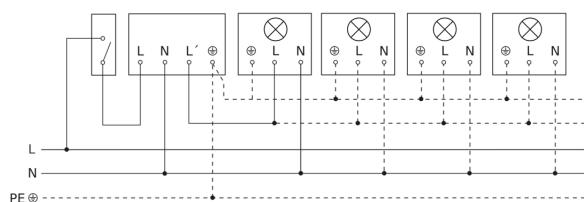
Raccordement par commutateur séquentiel pour la commande manuelle ou automatique
