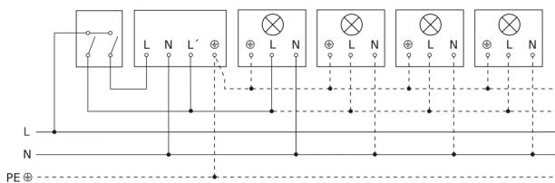
Schéma de câblage Raccordement via un commutateur pour l'éclairage permanent et le mode automatique
